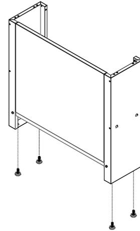
**4** Parafuse o painel frontal do check out nos cavaletes conforme indicado na imagem abaixo, determinando o lado de trabalho do operador.
