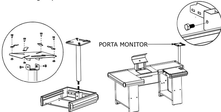
**11** Caso seu Check Out tenha cancela, encaixe as bases no arco, depois parafuse no cavalete conforme indicado na imagem abaixo.
