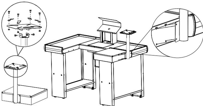
**11** Caso seu Check Out tenha cancela, encaixe as bases no arco, depois parafuse no cavalete conforme indicado na imagem abaixo.
