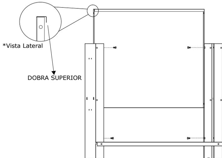
**4** Parafuse o painel frontal do check out nos cavaletes conforme indicado na imagem abaixo, determinando o lado de trabalho do operador.
